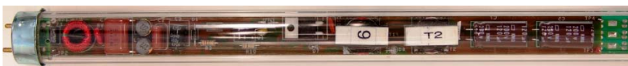
图3 – 显示T8灯管内LED驱动器的图片
