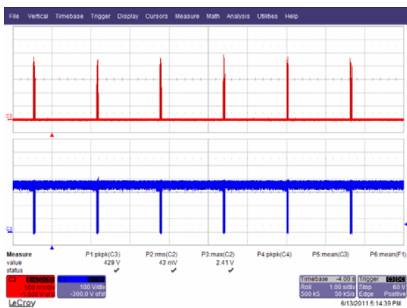
图42 – 265 VAC 50 Hz, 输出短路 上: I_{DRAIN} , 0.5 A/格 下: V_{DRAIN} , 100 V, 1 s/格
