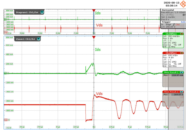
Figure 39 – 115 VAC. CH3: I_{DS} , 200 mA / div., 1 ms / div. CH4: V_{DS} , 100 V / div., 1 ms / div. Zoom: 2.5 \mu s / div. V_{DS(MAX)} = 269.57 V, I_{DS(MAX)} = 0.219 A.
