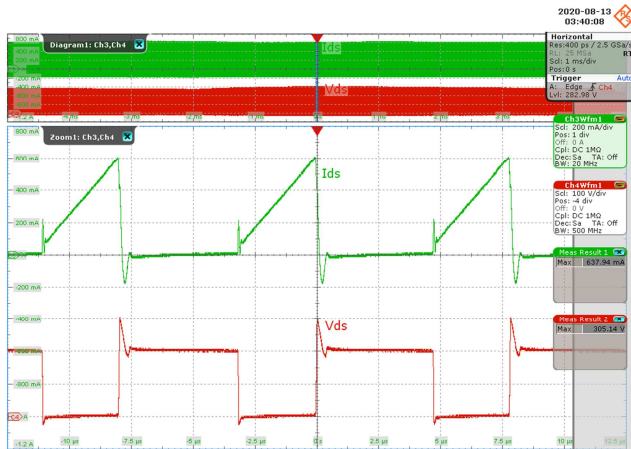
Figure 34 – 90 VAC. CH3: I_{DS} , 200 mA / div., 1 ms / div. CH4: V_{DS} , 100 V / div., 1 ms / div. Zoom: 2.5 \mu s / div. V_{DS(MAX)} = 305.14 V, I_{DS(MAX)} = 0.638 A.
