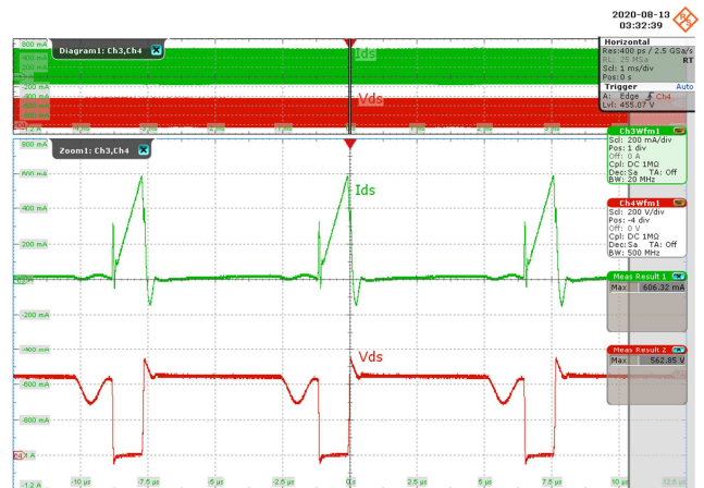
Figure 37 – 265 VAC. CH3: I_{DS} , 200 mA / div., 1 ms / div. CH4: V_{DS} , 200 V / div., 1 ms / div. Zoom: 2.5 \mu s / div. V_{DS(MAX)} = 562.85 V, I_{DS(MAX)} = 0.606 A.
