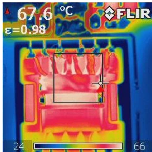
図 35 トランス (T1)。室温での温度の底面表示、最大負荷。
