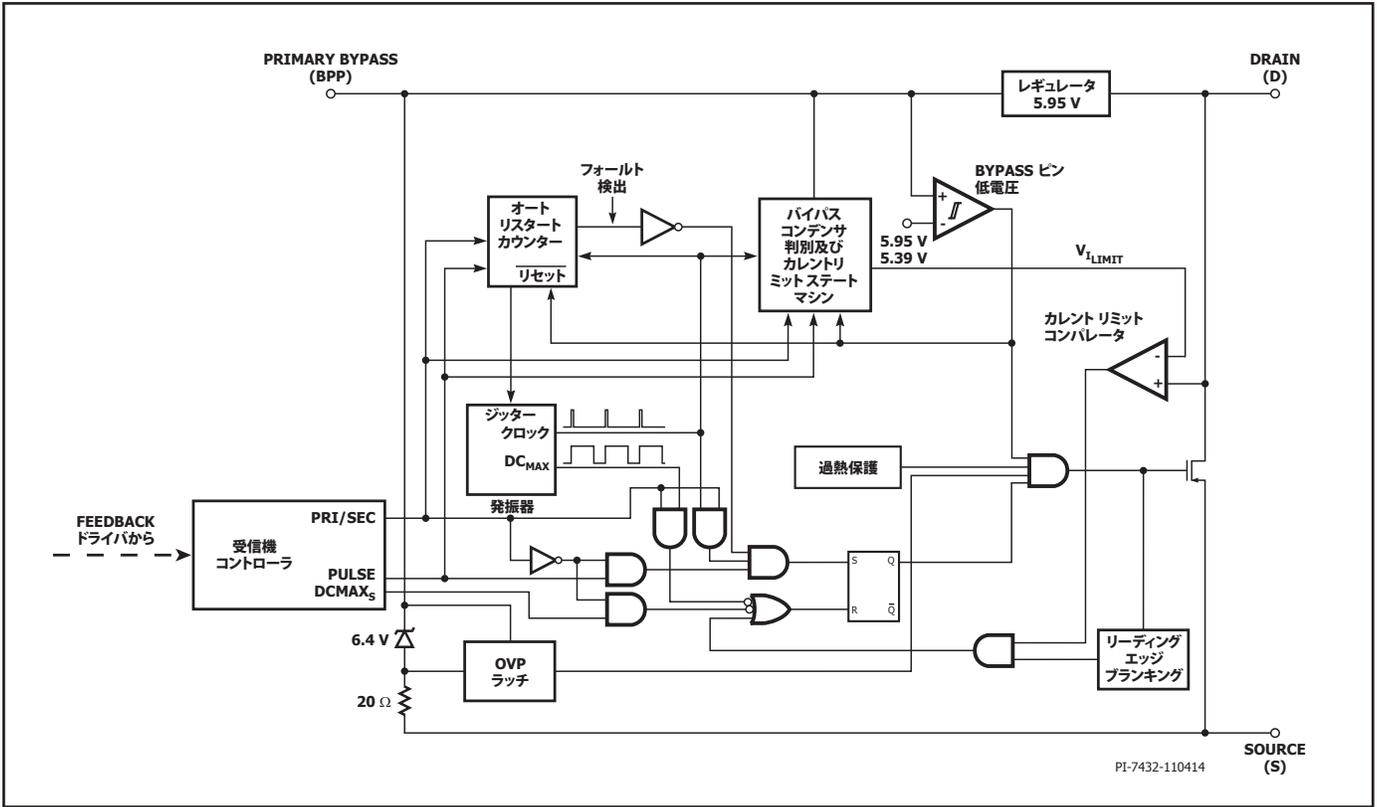
図 3. 一次側コントローラのブロック図
