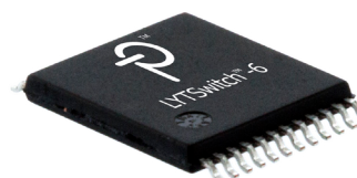
図 2. 高浴面距離、安全規格準拠 InSOP-24D パッケージ
